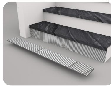
Una vez colocados los peldaños, procederemos a la colocación de las tabicas por el método del doble encolado. Es muy importante que no se toque cerámica con cerámica, dejando una junta mínima de 3 mm entre el peldaño y la tabica. Esta junta se deberá llenar de material de junta elástica e impermeable.
