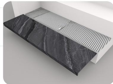
El adhesivo del soporte de la huella siempre se debe peinar en línea recta y perpendicular a una arista del escalón para conseguir un correcto reparto del adhesivo al presionar y evitar huecos.
