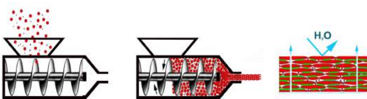
Proceso y estructura materiales extrudidos Gres Aragón. Process and structure of Gres Aragón extruded materials.
