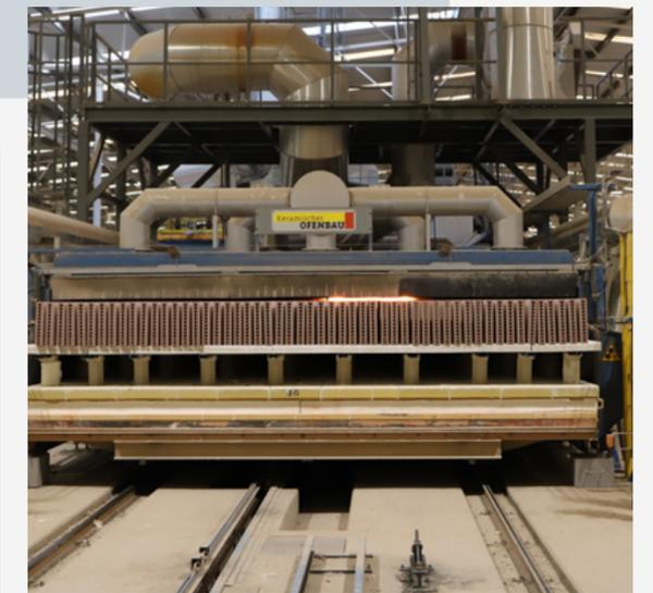
El calor residual de gases de los hornos se aprovecha en los secaderos, ahorrando así el gas natural necesario para el secado de piezas.
