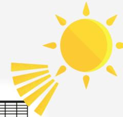
El sol incide directamente sobre el aplacado y no sobre el edificio, calienta el aire de la cámara, disminuye su densidad y por convección asciende, ocupando su lugar aire fresco. Este es el fenómeno denominado "efecto chimenea", que evita la acumulación de calor en la fachada.
