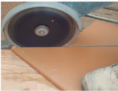
Fig. 1-Método de corte, con corte todo el espesor a la vez, avance lento, con el que no se rompen las baldosas.
