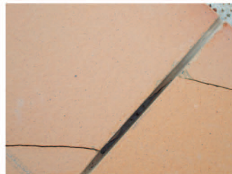
Fig. 2-Método de corte, con una primera incisión y una segunda etapa de corte del resto del espesor. No recomendado.
