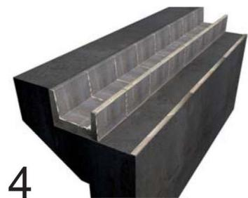
4 Colocar cemento cola en las uniones de las piezas para su fijación.
