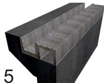
5 Puesta de la segunda hilada de piezas de hormigón, llaneando con material el perfil de unión y eliminando el sobrante con una espátula, así colocamos y rejuntamos a la vez.
